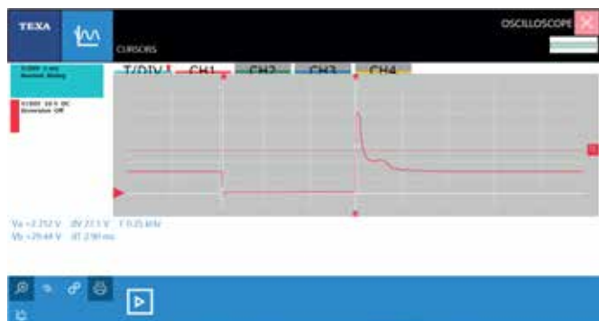
Figura 6: Acquisizione oscilloscopica del segnale di apertura di un iniettore
