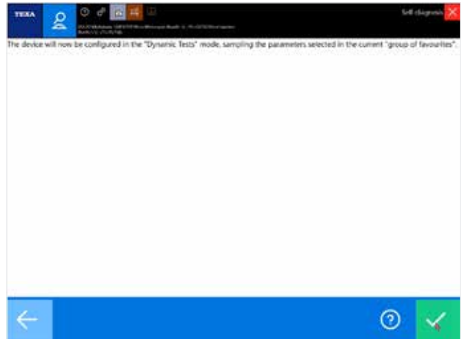
Figura 70: Confermando con il pulsante in basso a destra verrà installata nel TXB Evolution la diagnosi del gruppo di preferiti prescelto
