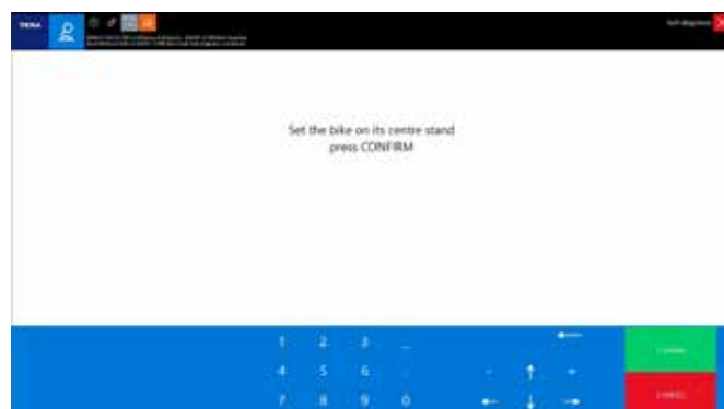
Figura 38: Il software IDC5 prima della fase effettiva di diagnosi può richiedere condizioni particolari, in questo caso viene chiesto di posizionare la moto sul cavalletto centrale
