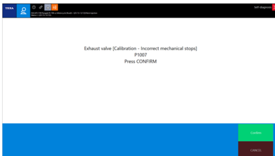
Figura 58: Il dettaglio dell'errore è sempre disponibile tramite doppio click. In questo caso il codice errore P1007 indica che la valvola allo scarico ha un problema meccanico nella posizione di riposo
