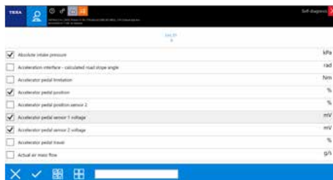
Figura 67: Dalla lista completa dei parametri si possono selezionare solo quelli per creare il gruppo logico
